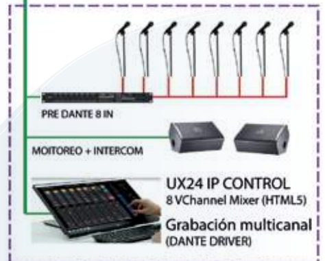
SOLIDYNE UX-24 A67 con módulo UDX A67 (DANCHE AoIP 16x16)
